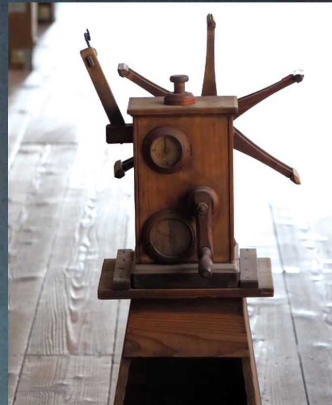
検尺機（生糸の長さや重さを測って織度（太さ）を測定するための道具）
